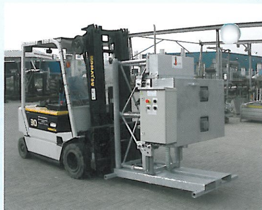
Aandrive-unit standaard voorzien motorbeschermkast, hier gemonteerd op motor-transportsteun met heftrucklepel-gaten. (optie)
